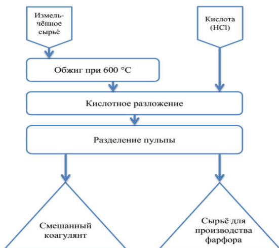
Рисунок 3 - Принципиальная технологическая схема получения смешанного коагулянта из каолиновых глин.
