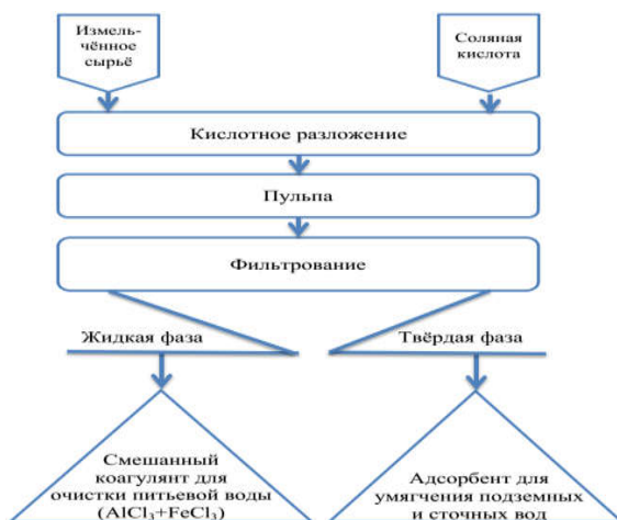
Рисунок 5 - Принципиальная технологическая схема переработки бентонитовых глин соляной кислотой.
