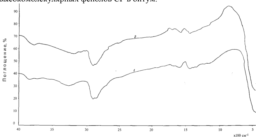
Рисунок 4. ИК-спектры «ГРМ+ \text{H}_2\text{SO}_4 +известь» до (1) и после (2) термообработки.
