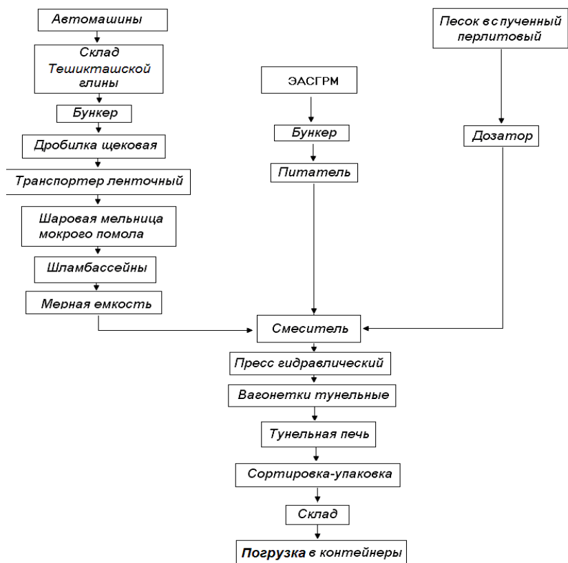
Рисунок 6. Технологическая схема производства керамоперлитовых изделий.
