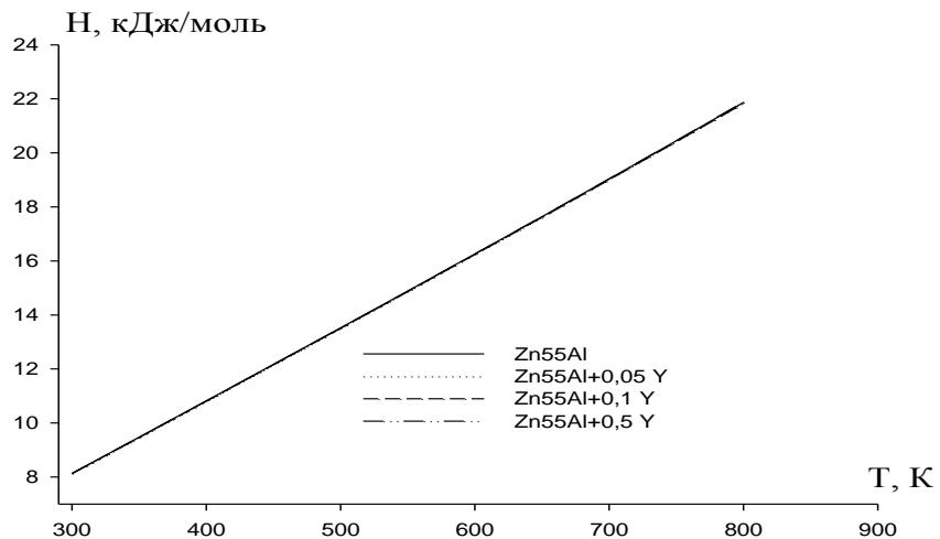
Рисунок 5. Температурная зависимость энталпии сплава Zn55Al, легированного иттрием.
