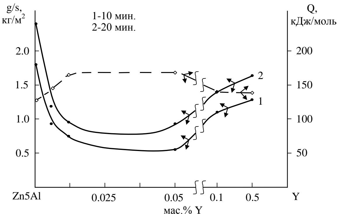
Рисунок 8. Изохроны окисления (573 К) сплава Zn5Al, легированного иттрием.
