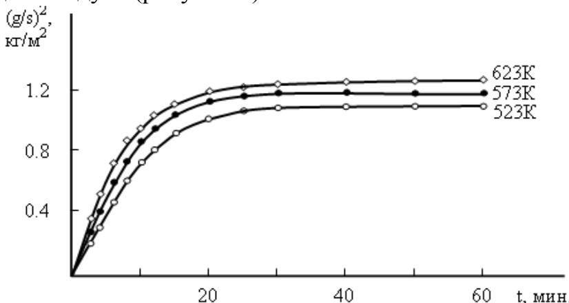
Рисунок 6. Кинетические кривые окисления сплава Zn5Al, содержащего 0.5 мас.% скандий.
