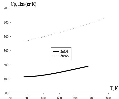
Рисунок 2. Температурная зависимость удельной теплоемкости сплавов Zn5Al и Zn55Al.
