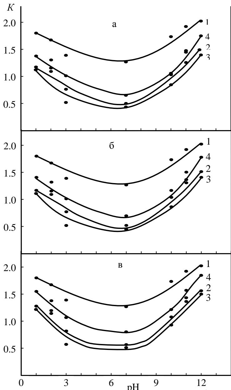
Рисунок 8. Зависимость скорости коррозии ( $K \cdot 10^{-3}, \text{г} \cdot \text{м}^{-2} \cdot \text{ч}^{-1}$ ) сплава Zn5Al(1), содержащего 0.005 (2), 0.05 (3) и 0.1 мас.% (4) скандий (а), иттрий (б) и эрбий (в) от pH среды.
