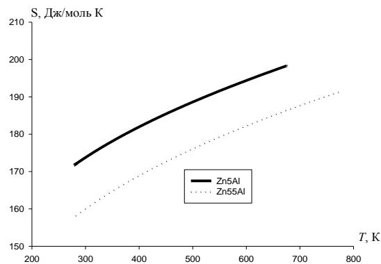
Рисунок 3. Температурная зависимость энталпии сплавов Zn5Al и Zn55Al.
