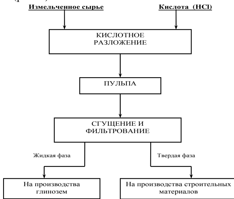
Рисунок 6 - Принципиальная технологическая схема комплексной переработки ставролит-сланцев кислотным методом
