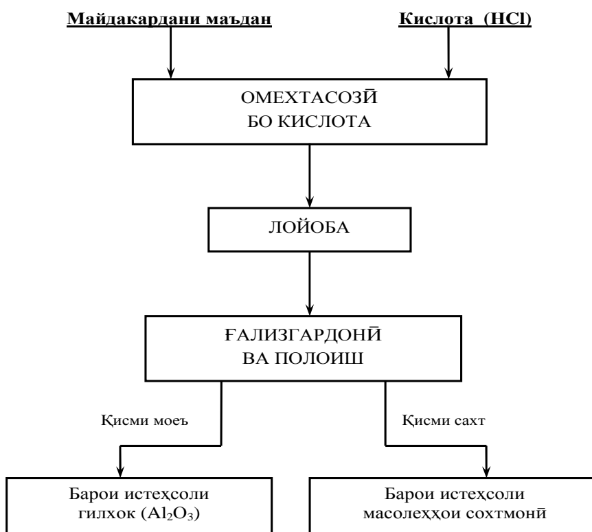
Расми 6 - Нақшаи усули технологии бозкоркарди комплекси ставролити слансҳои ставролити слюдадор бо методи кислотагӣ
