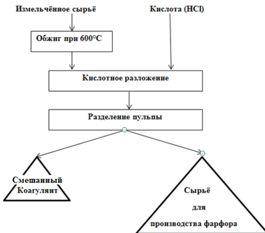
Рисунок 13 - Принципиальная технологическая схема получения смешанного коагулянта из каолиновых глин.
