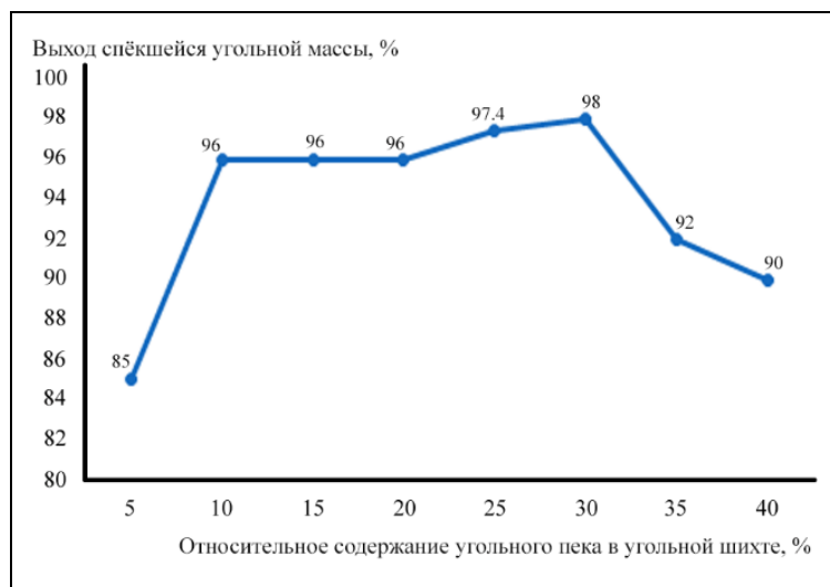
Рисунок 8 - Процент спекшейся шихты, состоящей из угля месторождений «Назар-Айлок» и «Фон Ягноб» в зависимости от содержания в шихте
