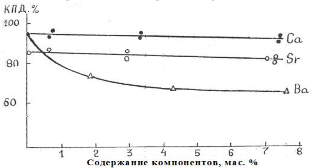
Рисунок 1.9 - Зависимость скорости коррозии алюминиевых сплавов от содержания кальция, стронция и бария в сплаве
