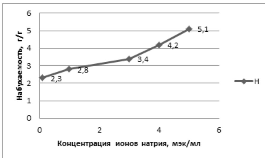
Рисунок 3.18 - Влияние десорбции ионов \text{Cu}^{2+} на набухающую способность полисахаридных сорбентов
