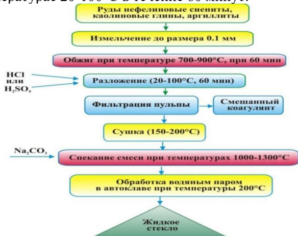
Рисунок 15. Технологическая схема получения жидкого стекла
