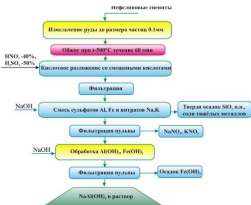
Рисунок 9. Принципиальная технологическая схема переработки нефелиновых сиенитов смешанными кислотами
