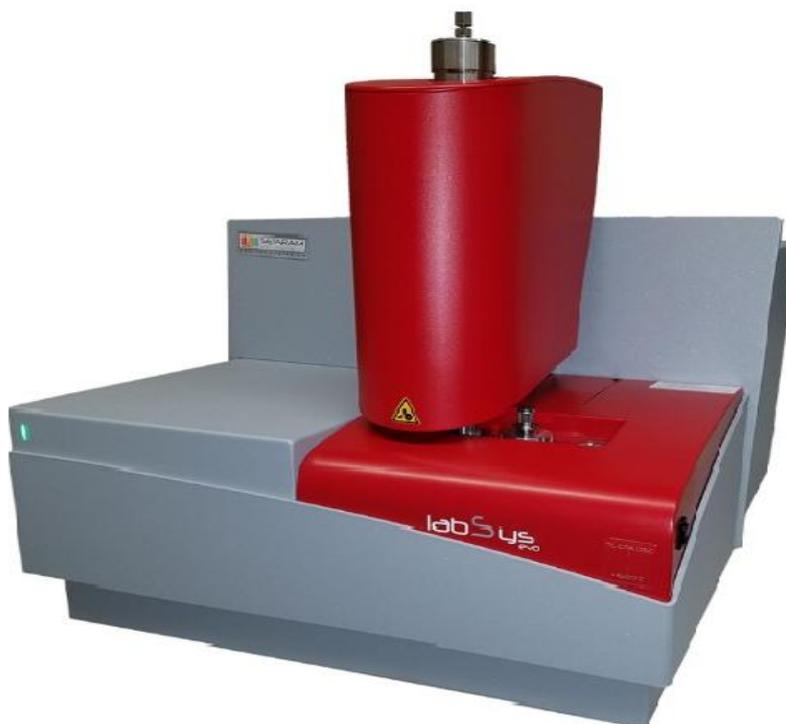
**Рисунок 2.6.** Дериватограф "Labsys Evo-C1600" фирмы "Setaram".
