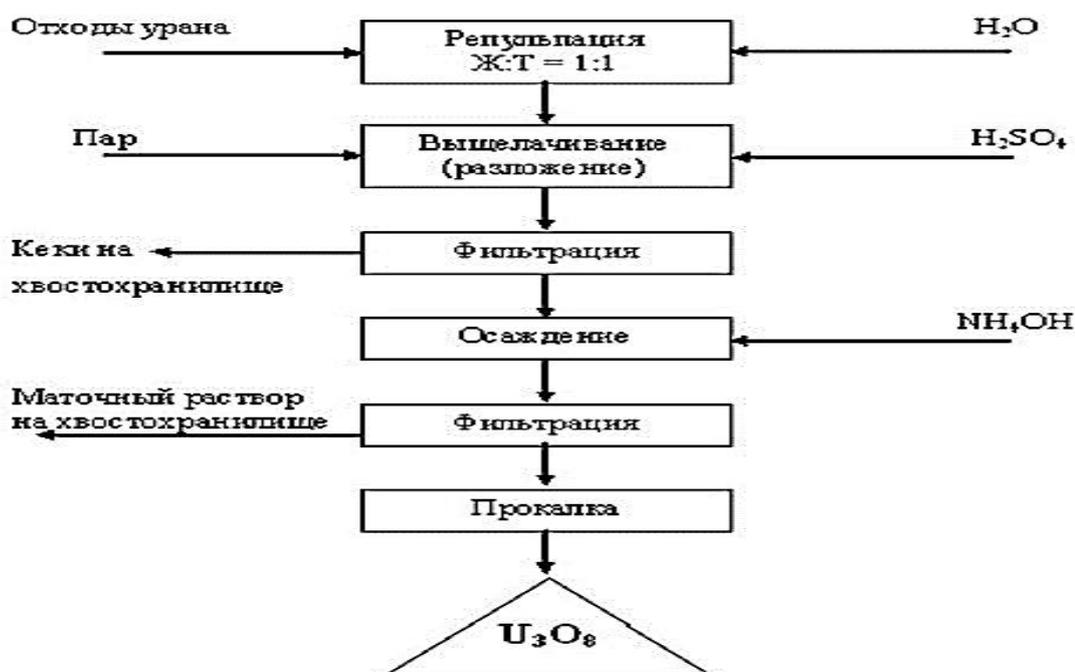
**Рисунок 2.14.** Обобщённая схема технологических процедур переработки ураносодержащих отходов.
