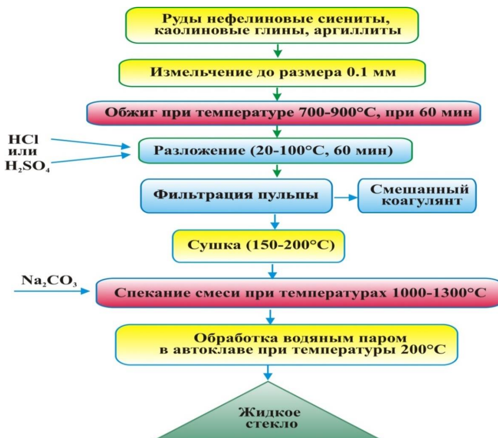
Рисунок 3.27. Технологическая схема получения жидкого стекла.
