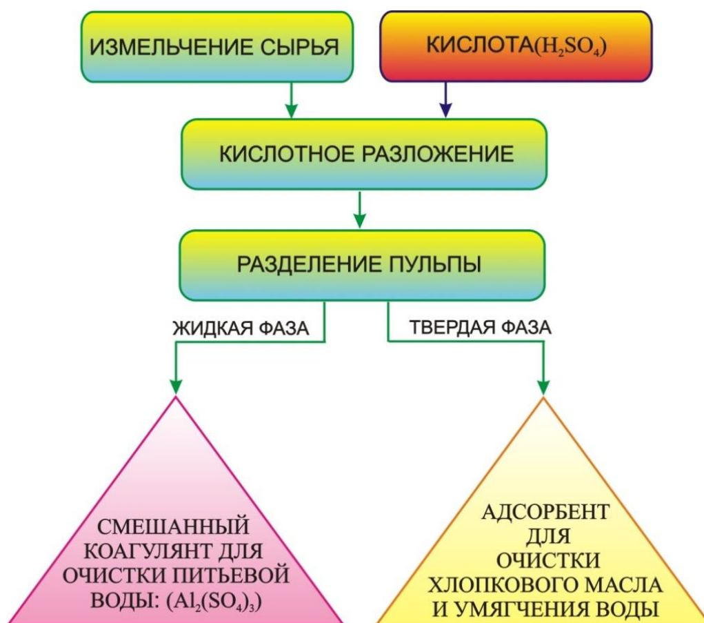
Рисунок 1.6. Обобщённая упрощённая технология кислотного разложения бентонитовой глины.
