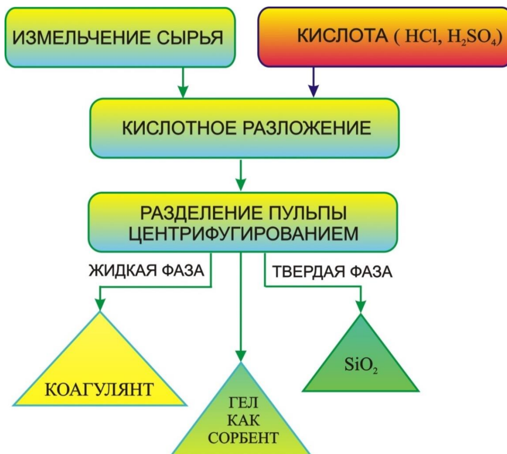
Рисунок 1.5. Обобщённая упрощённая технологическая схема по кислотной переработке цеолитовой руды.
