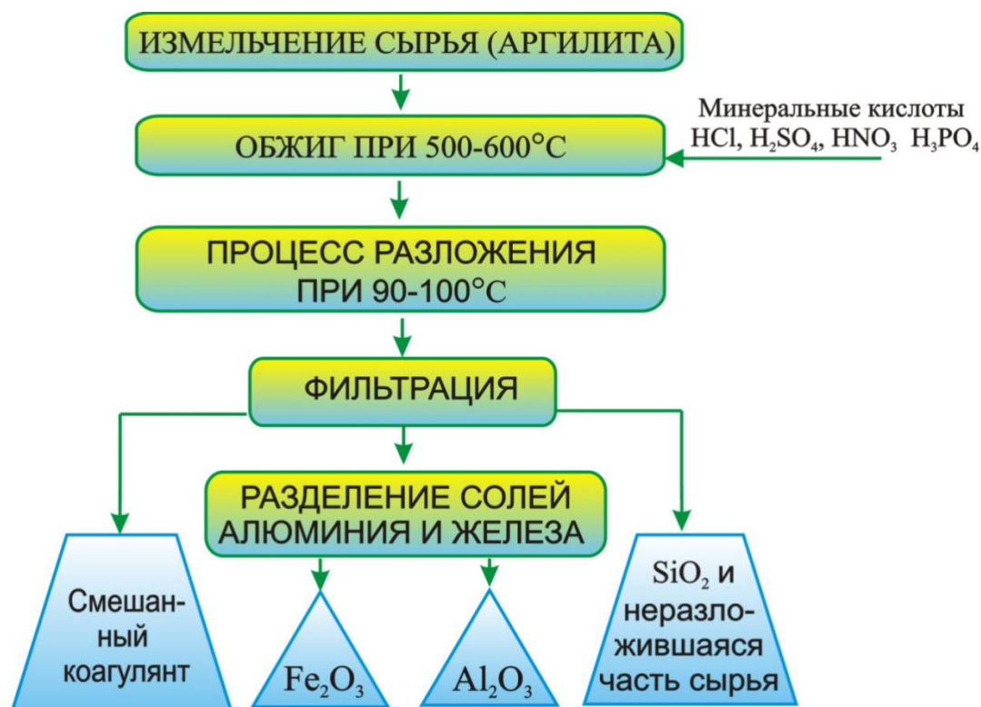
Рисунок 3.29. Общая упрощённая технология для кислотной переработки аргиллитового сырья Чашма–Санг.
