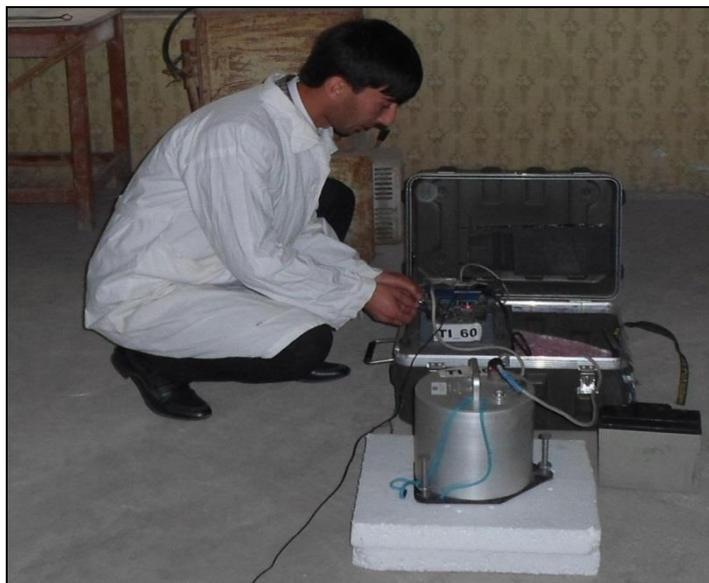
Рисунок 2.1. Пример измерения сейсмического шума в полевых условиях с применением сейсмической станции 45 EDL
