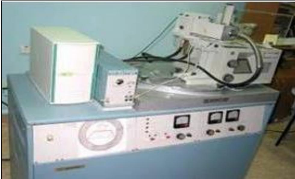
Рисунок 2.10. Установка ДРОН-3
