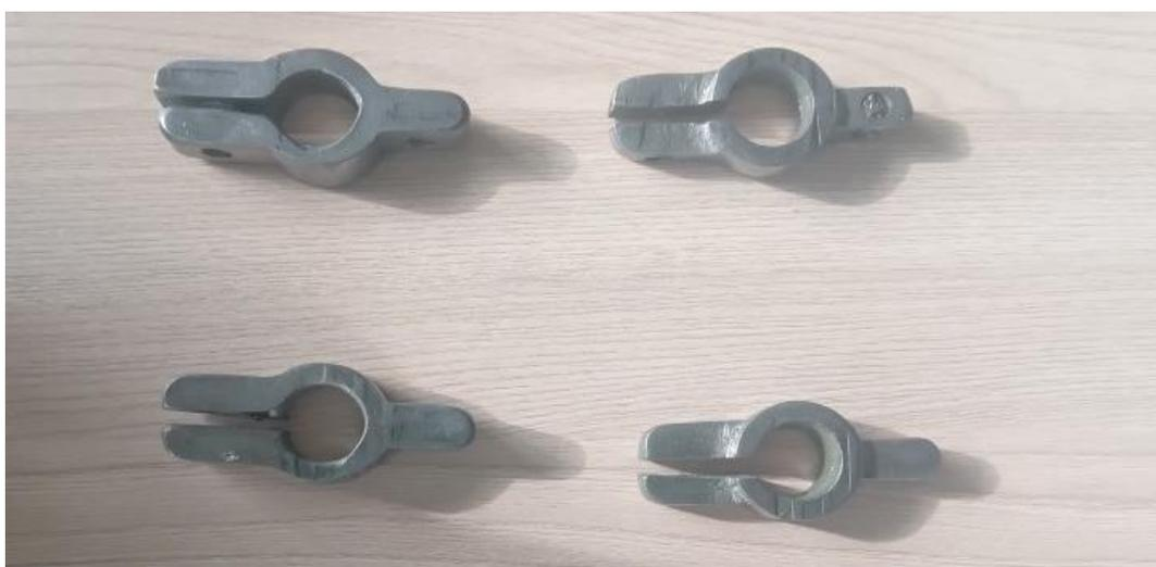
Рисунок 4.1. Аккумуляторные клеммы полученные в условиях защиты от микросейсм
