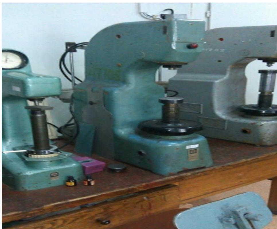
Рисунок 2.3. Твердомер ТШ-2
