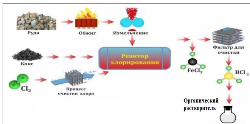
Рисунок 10.- Лабораторная установка для хлорирования боросиликатов (датолита, данбурита)
