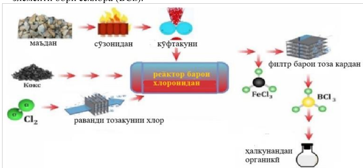
Расми 10. - Нақшаи дастгоҳи озмоишӣ барои хлоркунонии минералҳои боросиликатӣ (данбурит ва датолит)
