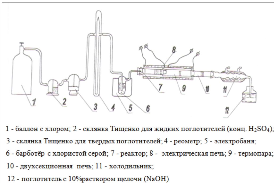
Рисунок 1.2. - Экспериментальная установка для анализа хлорирующего обжига данбурита Ак-Архарского месторождения
