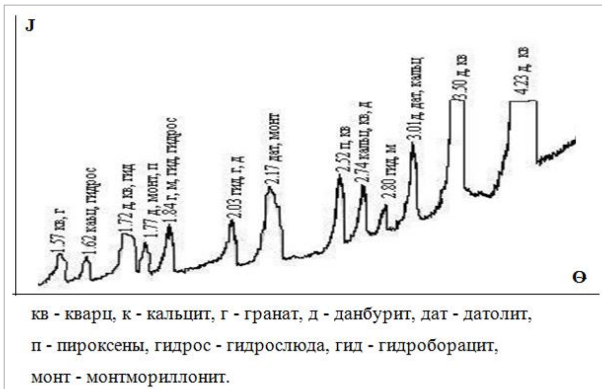
Рисунок 1.8. - Рентгенографическая характеристика данбуритовой породы после термической обработки
