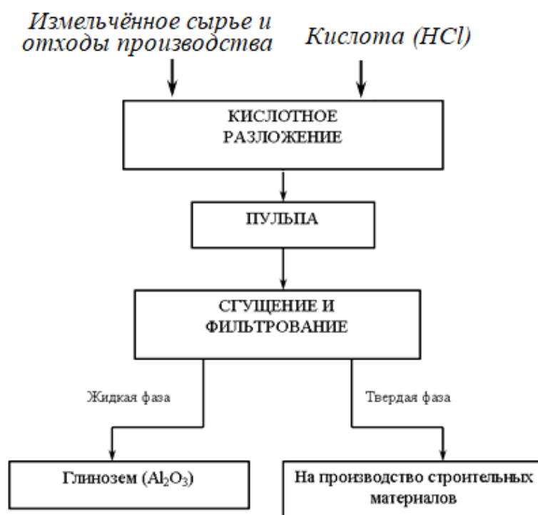
Рисунок 4. – Обобщённая технологическая схема комплексной переработки мусковитсодержащего концентрата и отходов шламовых полей кислотным методом
