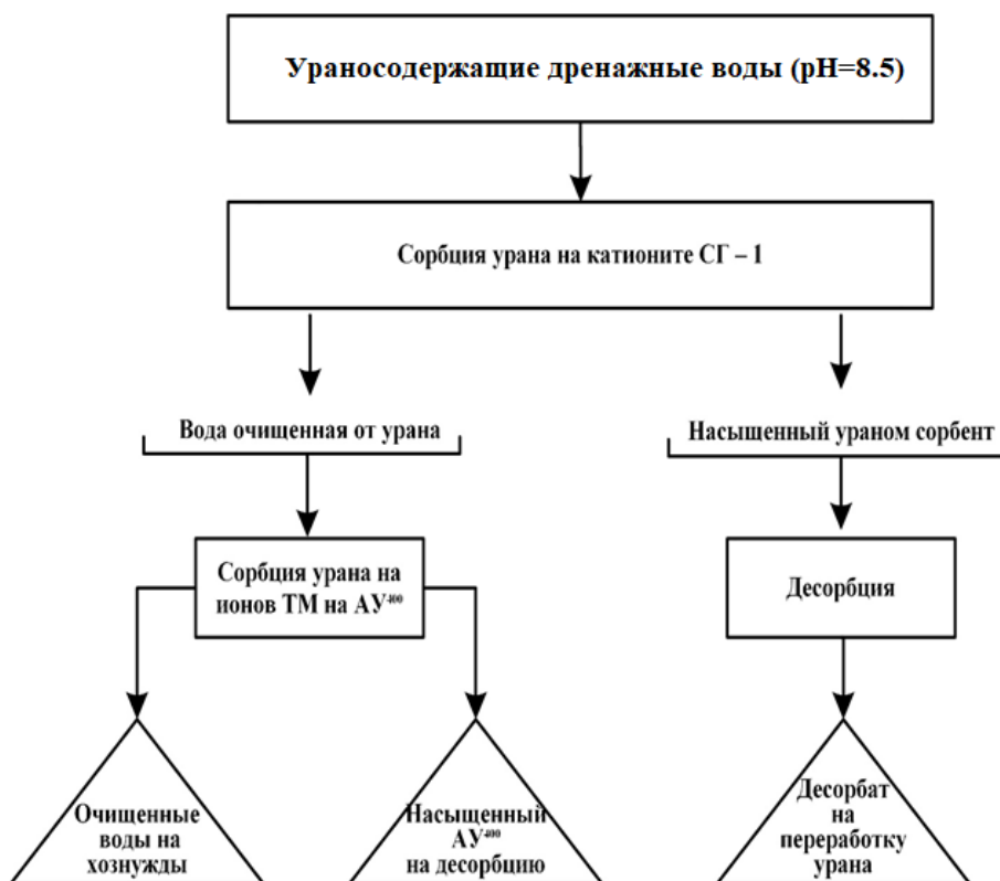
Рисунок 9. - Усреднённая схематическая технология для сорбции урана из дренажных вод и удаления из них тяжёлых металлов
