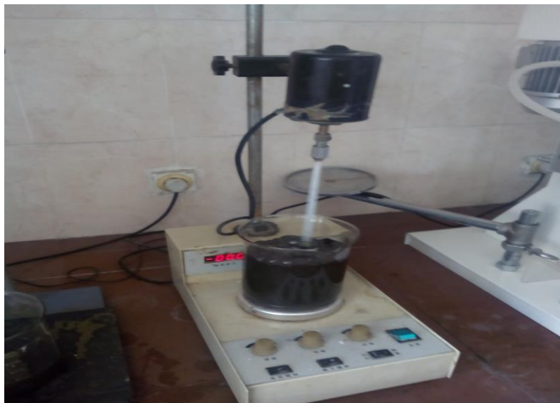
Рисунок 5. - Лабораторная установка для исследования разложения флотационных концентратов растворами \text{HNO}_3
