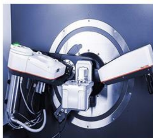
Рисунок 2.4. - Комплекс «XRDynamic-500» - дифрактометр автоматизированный многоцелевой порошковый рентгеновский
