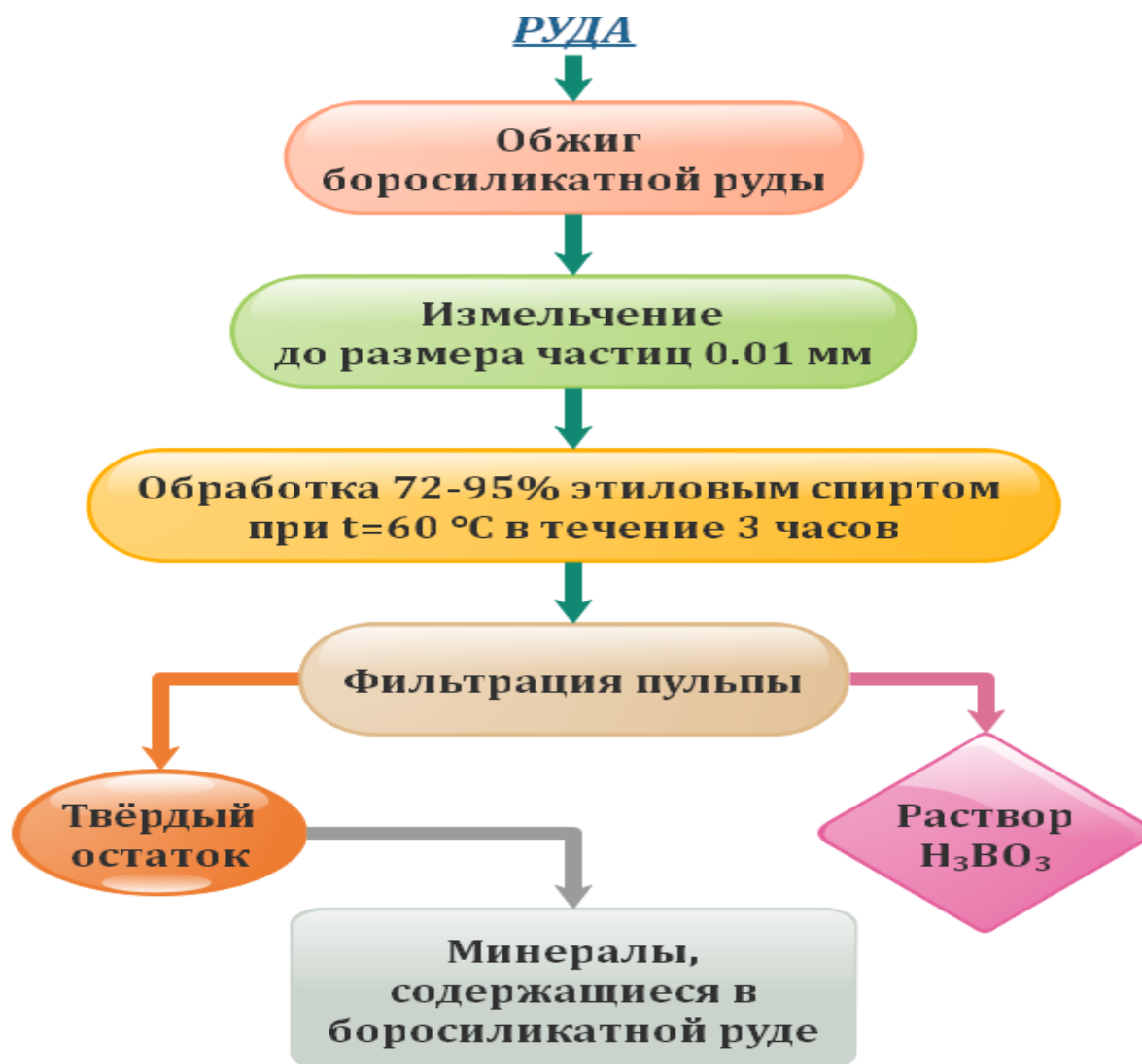
Рисунок 3.4. - Технологическая схема получения медицинской H_3BO_3
