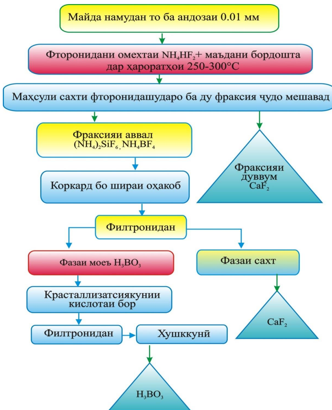
Расми 14. – Нақшаи технологии таҷзияи маъдани боросиликатӣ бо гидрофториди аммоний
