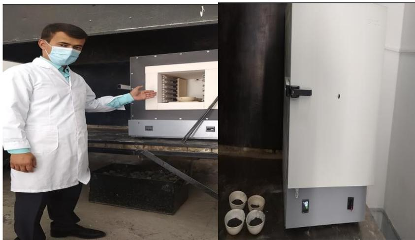
**Рисунок 3.6.** – Процесс обжига смеси сульфидно-сурьмяного концентрата и хлорида натрия в печи ПЛ 5/12.5
