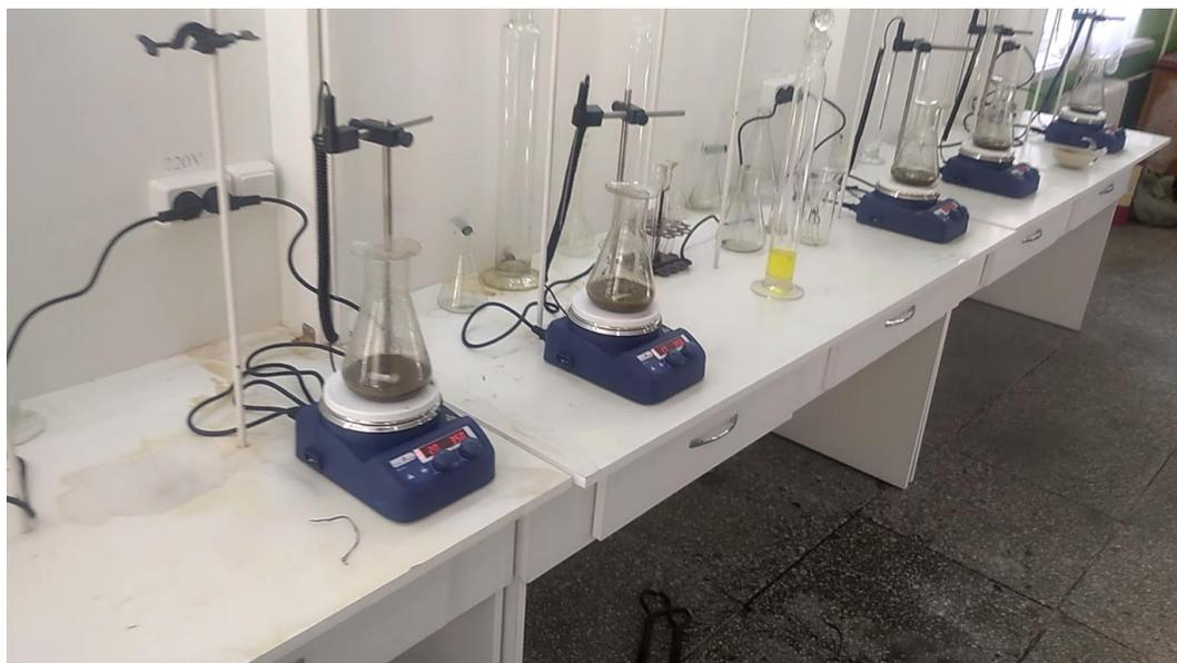
**Рисунок 4.2.** – Установки для солянокислотного и водного выщелачивания сурьмасодержащих огарков
