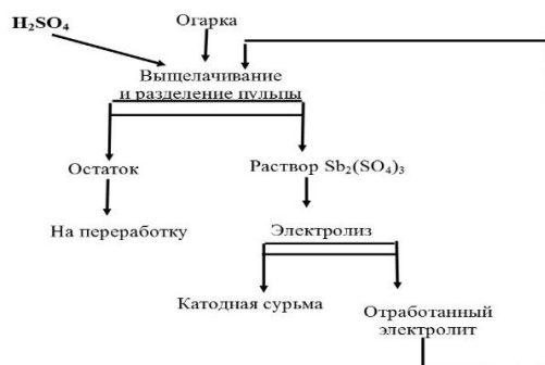
Рисунок 13. - Принципиальная технологическая схема, гидromеталлургического способа переработки сурьма содержащих огарков
