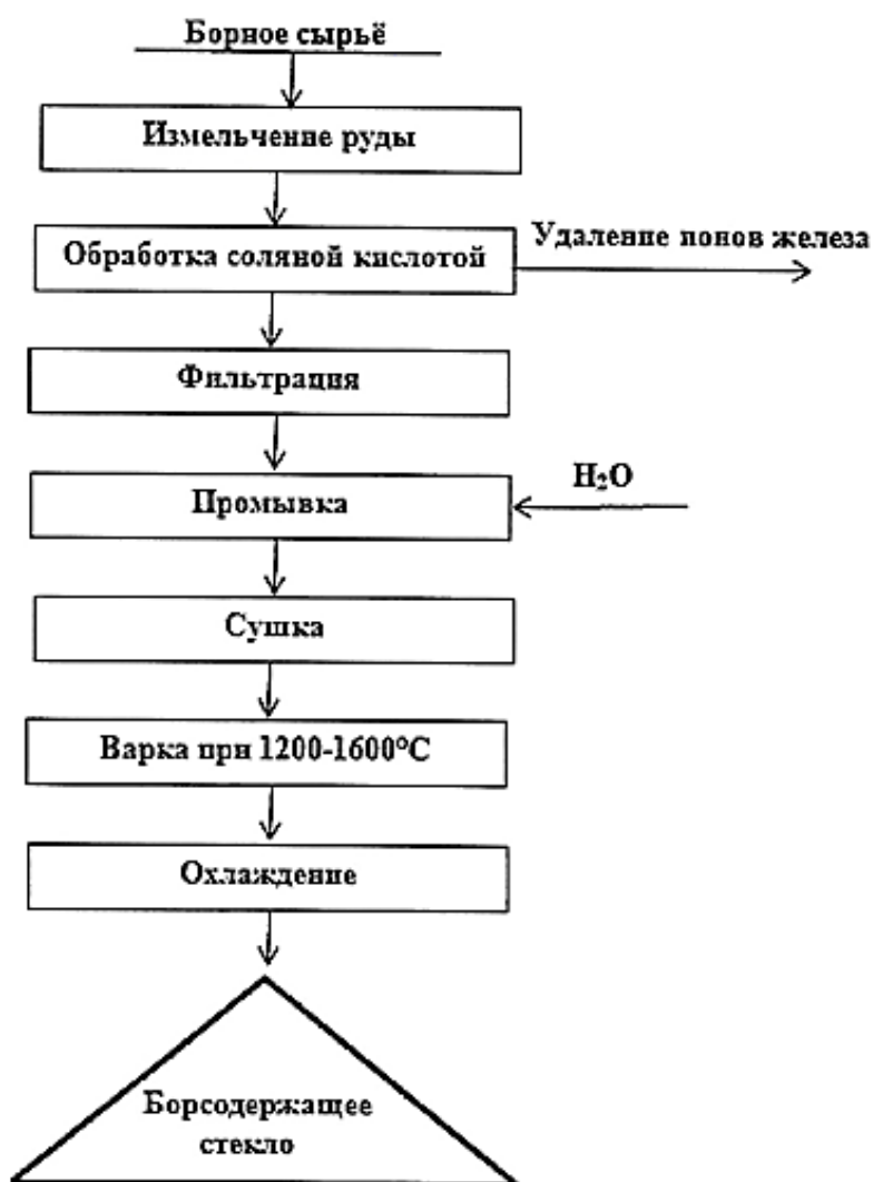
Рисунок 1.2. – Технологическая схема получения боросиликатного стекла
