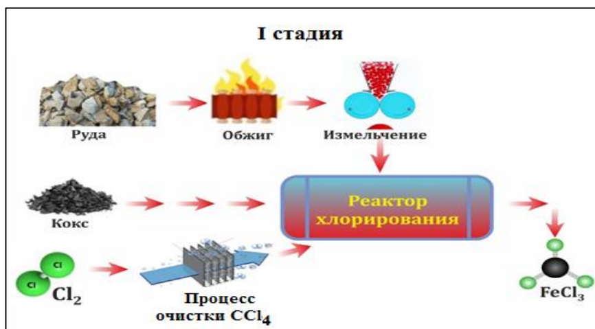
Рисунок 2.7 - Принципиальная технологическая схема получения \text{FeCl}_3 – обезжелезивание.
