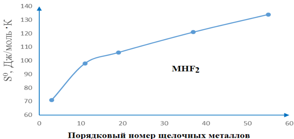
Рисунок 4 - Закономерности изменения энтропии MHF_2 в зависимости от порядкового номера щелочных металлов.
