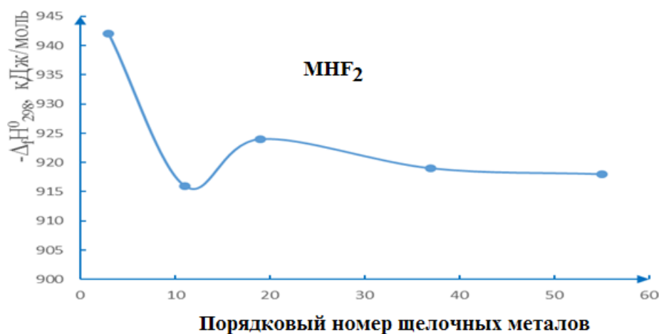
Рисунок 2 - График зависимости энтальпии образования гидротрифторидов состава MHF 2 от порядкового номера щелочных металлов.
