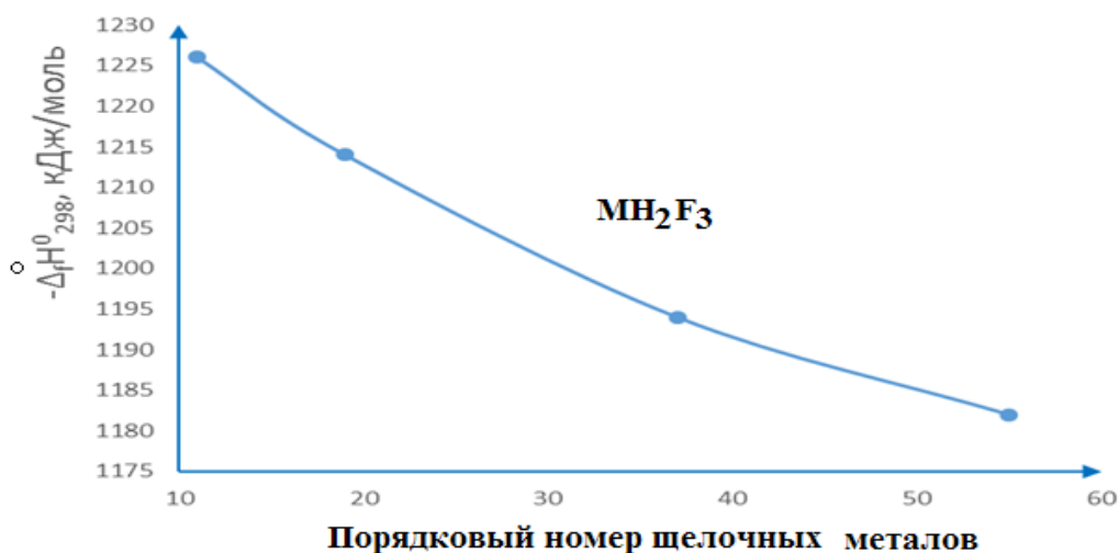
Рисунок 3 - Зависимость энтальпии образования MH_2F_3 от порядкового номера щелочного металла.
