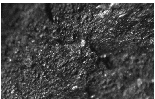
c. Микроструктура антрацита термообработанного при 1400^{\circ}\text{C} , \times 450
