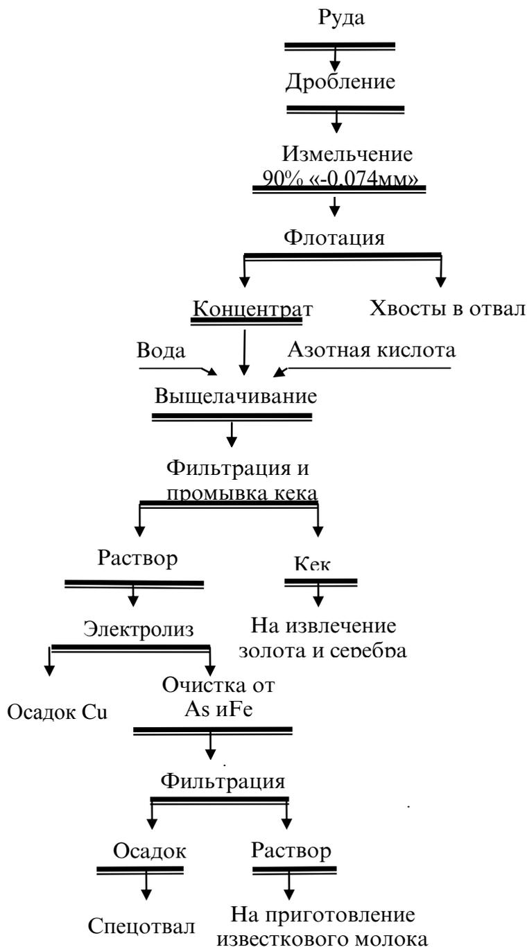
Рисунок 11 – Принципиальная технологическая схема переработки золото-, медно-, мышьяксодержащей руды месторождения Тарпор.
