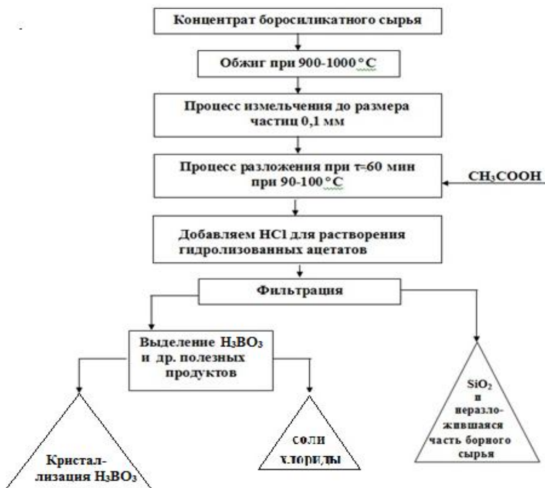
Рисунок 11 - Принципиальная технологическая схема переработки боросиликатных руд уксуснокислотным способом.
