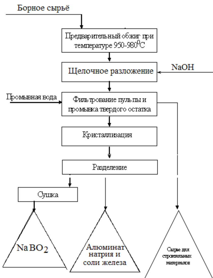
Рисунок 1.2 - Принципиальная технологическая схема переработки борного сырья щелочным способом.
