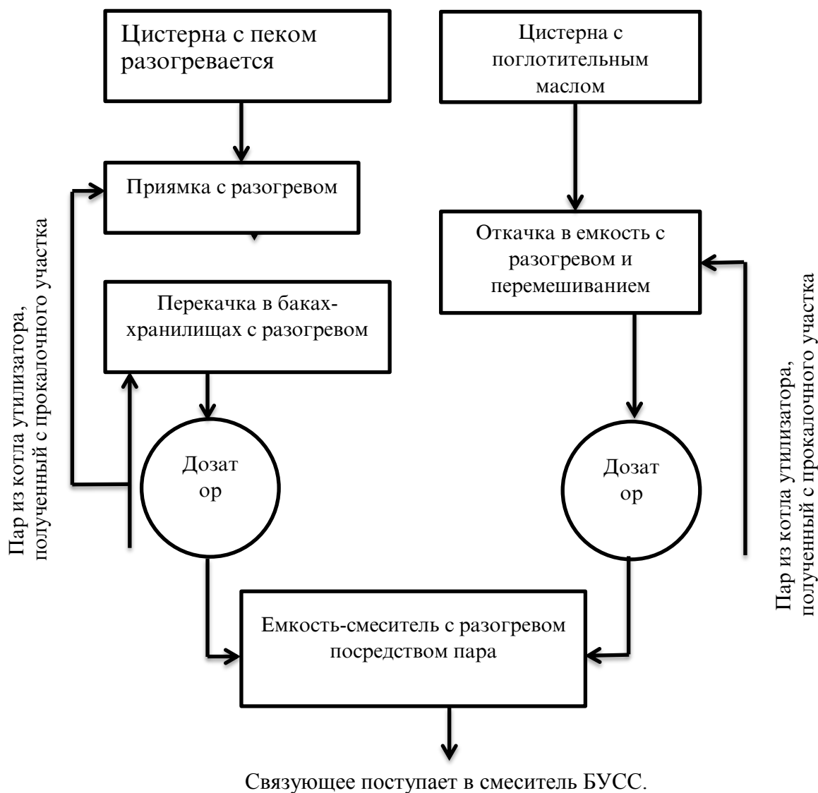
Рисунок 29. Технологическая схема подготовки связующего
