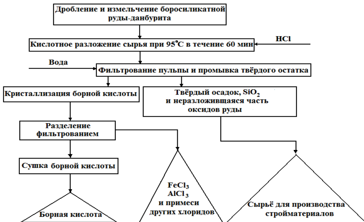
Рис.13. Принципиальная технологическая схема получения борной кислоты из данбуритовой руды месторождения Ак-Архар солянокислотным способом.
