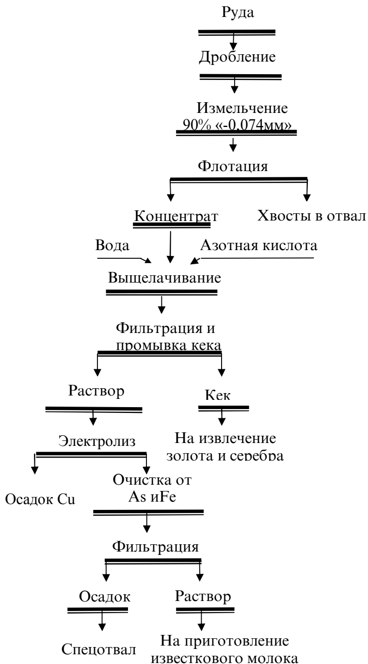
Рисунок 10 – Принципиальная технологическая схема переработки золото-, медно-, мышьяксодержащей руды месторождения Тарор.
