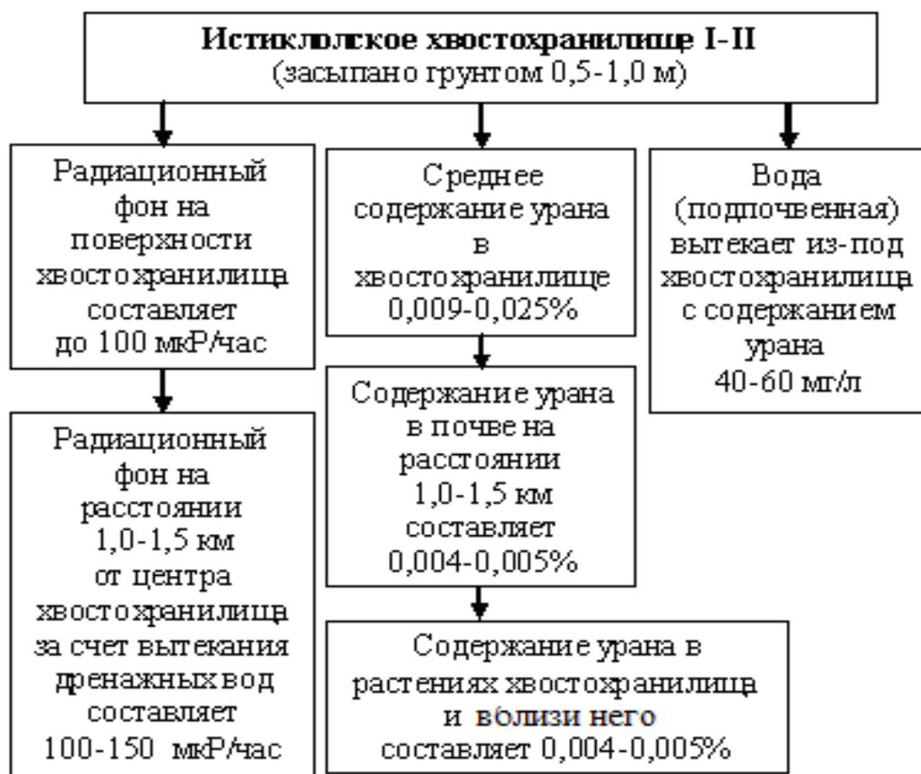
Рисунок 4.5. Схема Истиклолского хвостохранилища I-II.
