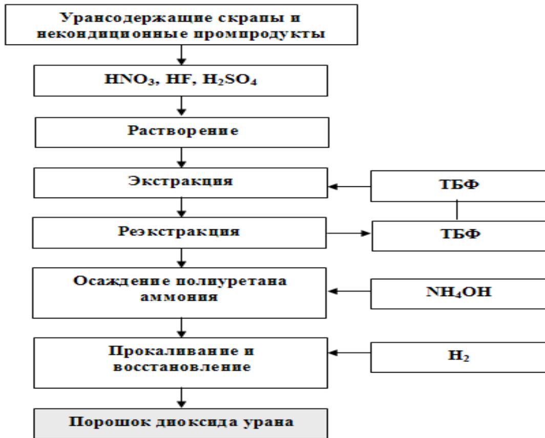
**Рисунок 1.1.** Схема процесса переработки урансодержащих остатков основного производства.
