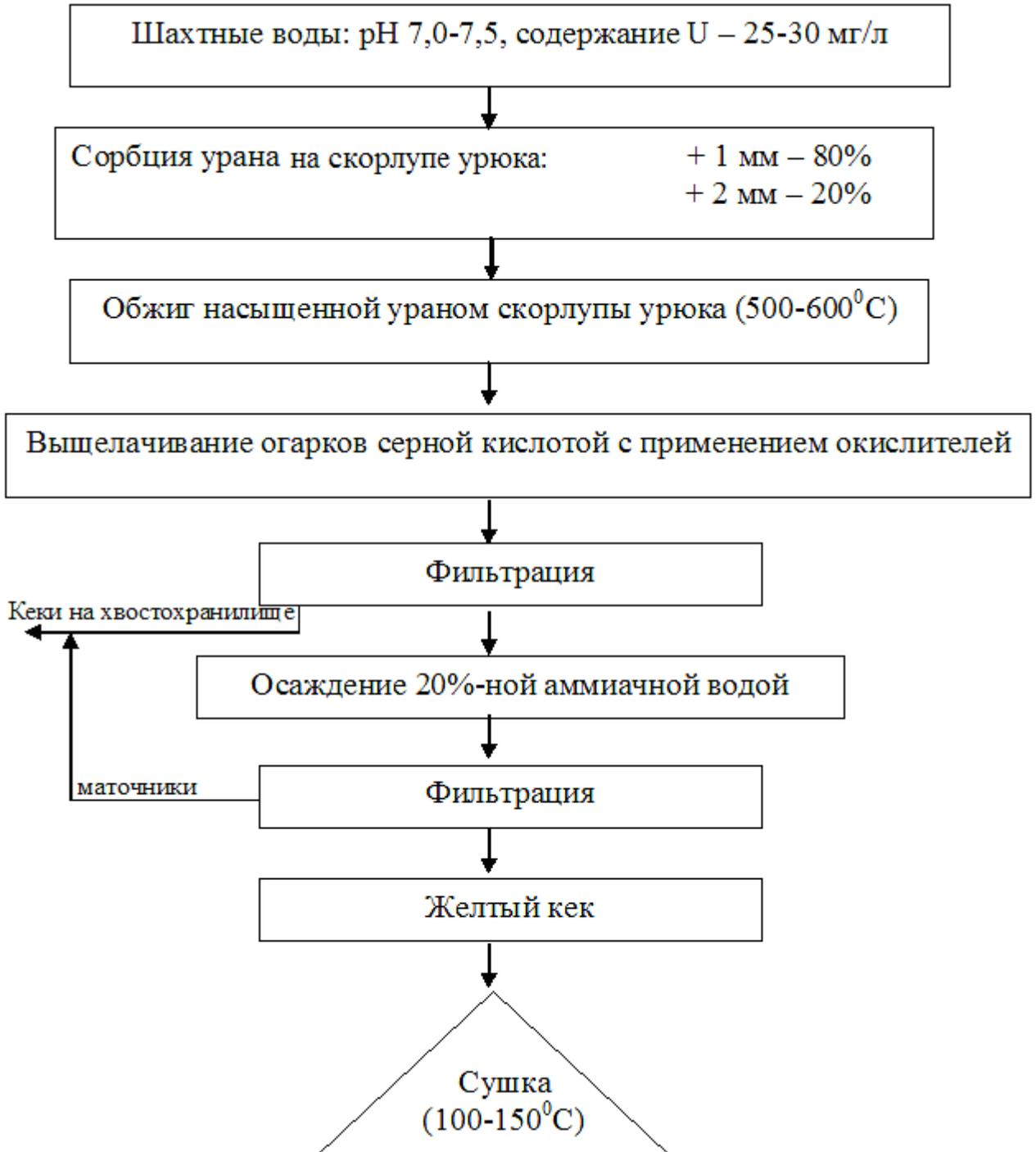
**Рисунок 3.20.** Принципиальная технологическая схема извлечения урана из шахтных и технических вод отходов урановой промышленности.
