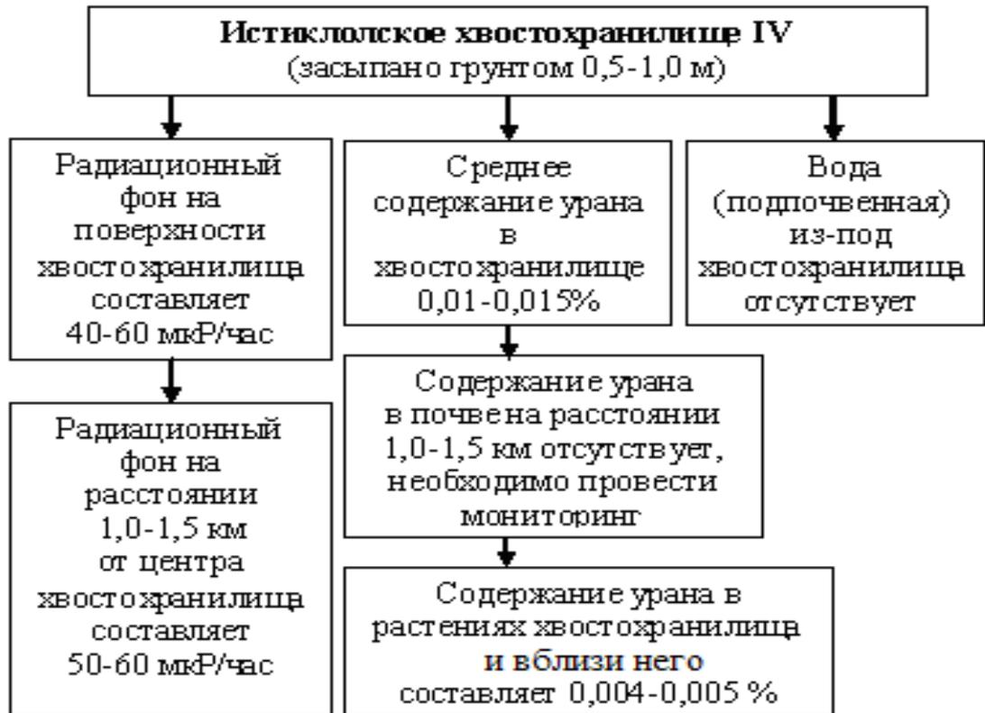
Рисунок 4.7. Схема Истиклолского хвостохранилища IV.
