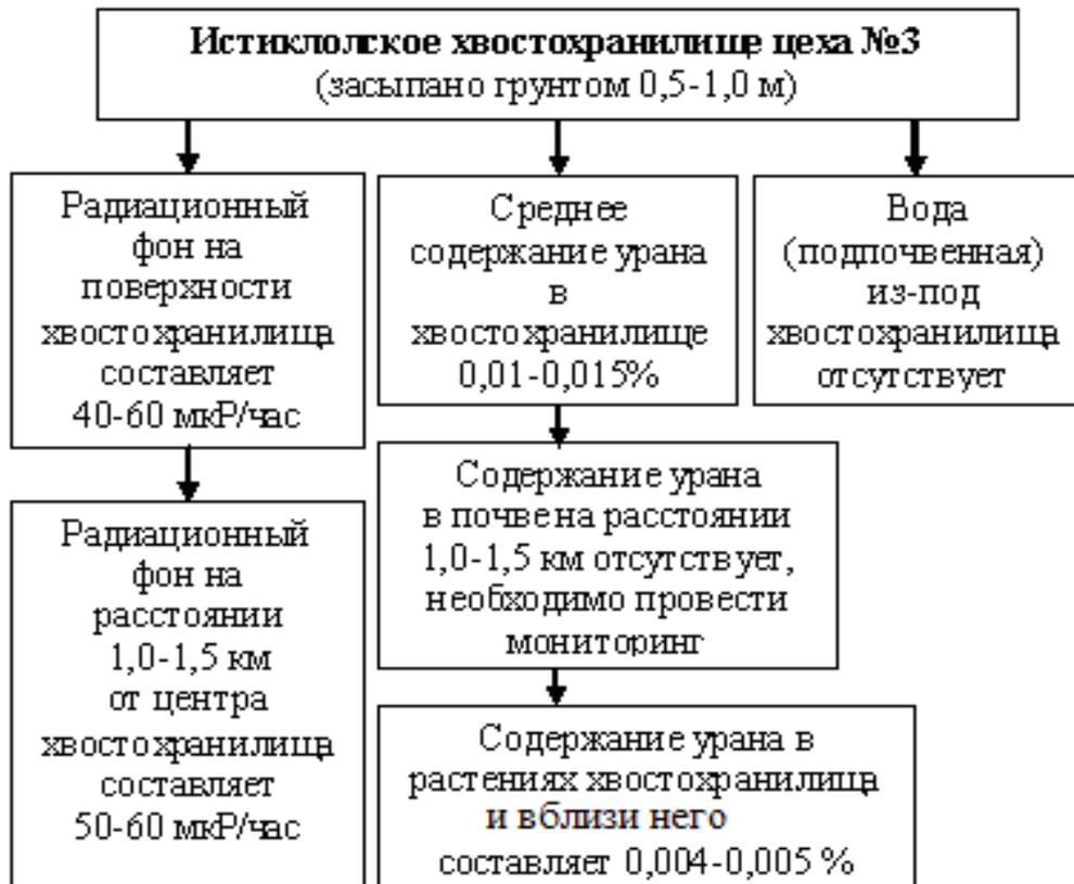
Рисунок 4.8. Схема Истиклолского хвостохранилища цеха №3.
