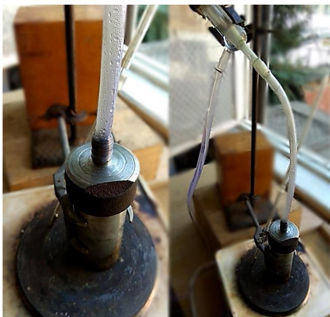
Рисунок 3.4.1. – Лабораторная установка для проведения сульфатизации 1-электрической нагреватель; 2-штатив; 3-фарфоровой тигель; 4-реактор; 5-соединитель; 6-обратный холодильник.
