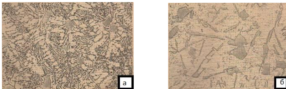
Рисунок 2.1. Микроструктуры (x300) сплава состава Al-Si: а) охлажденного в кокиле; б) медленная кристаллизация.
